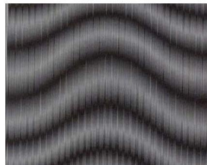
شکل ۲. فریزهای ماره که از روی هم قرار دادن دو توری مشابه چاپ شده توسط چاپگر به دست می‌آیند، زاویه بین بردارهای توری‌ها ۱۷۸٫۵ درجه است.
