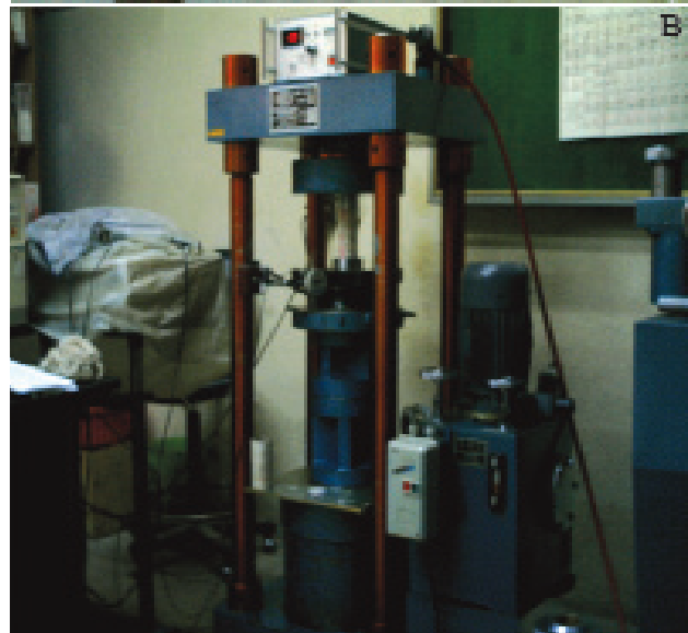
تصویر ۱- نحوه‌ی انجام آزمایشات، (A) آزمایش بار نقطه‌ای، (B) آزمایش مقاومت تراکمی تک محوری
