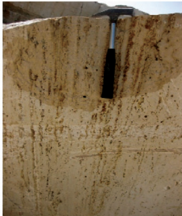
تصویر ۴- تاثیر اکسید آهن و مواد ارگانیک در تغییر رنگ و بافت لایه‌ای تراورتن تزرچ
