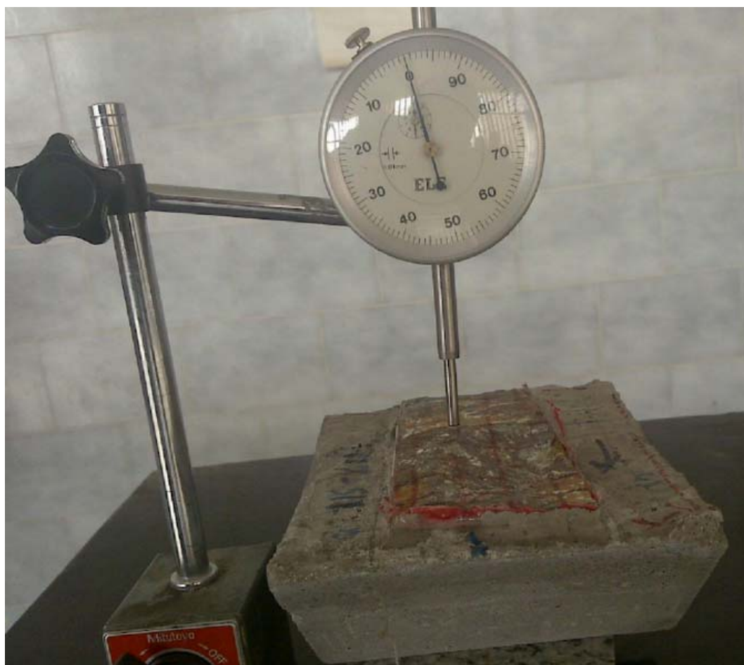
تصویر ۲- نحوه برداشت زبری سطح درزه در آزمایشگاه
