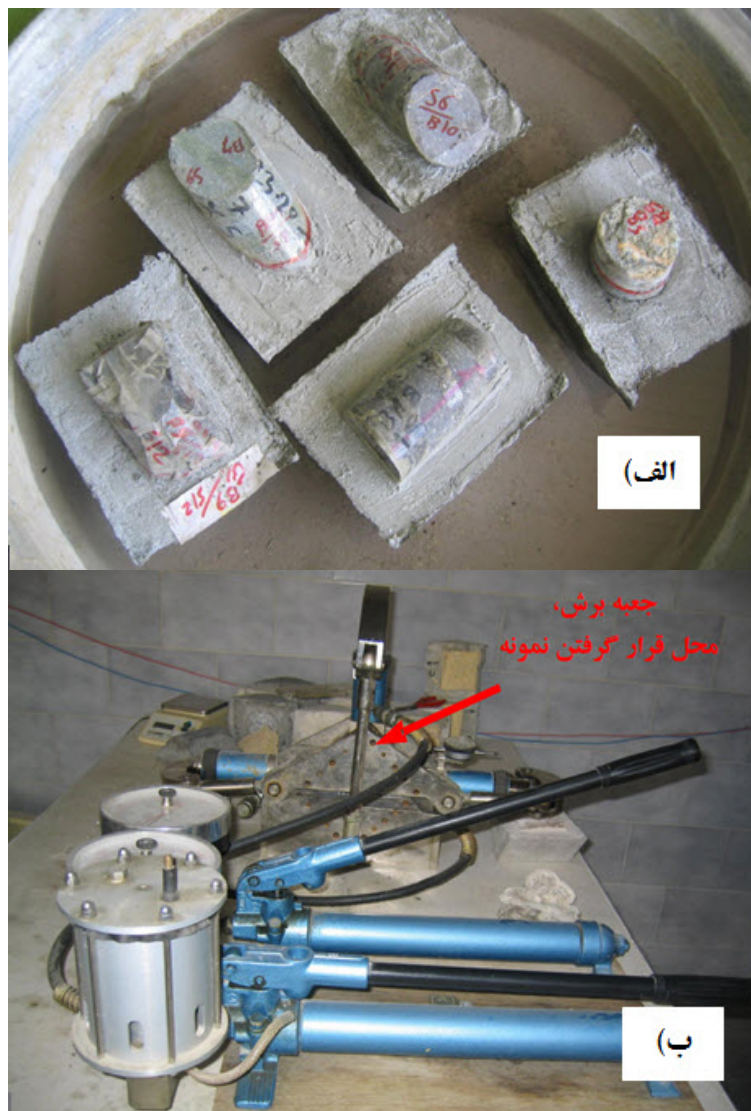
تصویر ۱- آزمایش برش مستقیم بر روی نمونه سنگی، (الف) آماده‌سازی نمونه‌ها برای آزمایش، (ب) دستگاه آزمایش برش مستقیم و چگونگی اعمال نیرو
