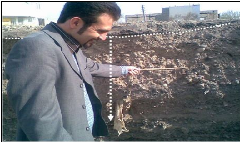
شکل ۴. فقدان زیرساخت لازم وجود زباله های شهری در بین لایه ها موید جوان بودن و عدم تحکیم یافتگی مواد آبرفتی سیلابی حواشی مسیل یر شده باغمیشه و سعدی می باشد که با فرونشست آسفالت تخریب می‌شود. منبع: نگارنده، ۱۳۸۷
