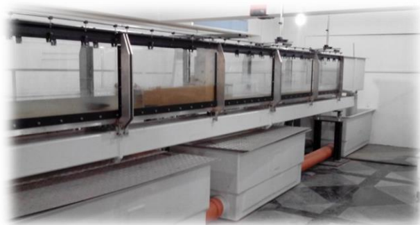
شکل ۳- تصویر فلوم آزمایشگاهی در شرایط آزمایش
