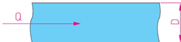
شکل ۱ - نمایشی از دبی حجمی در لوله
