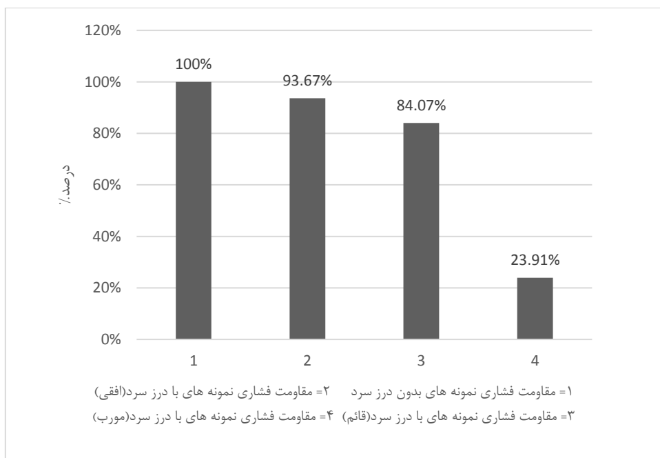
نمودار ۱- نمودار نسبت مقاومت فشاری نظیر احتمال ۵ درصد خرابی همه حالات نسبت به حالت بدون درز
