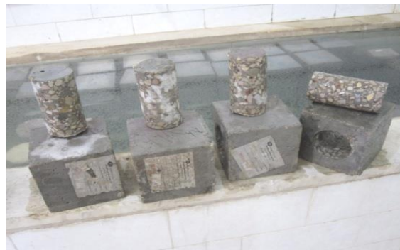
شکل ۹- مغزه‌گیری از نمونه‌های مکعبی
