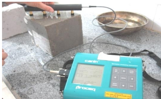
شکل ۱۱- دستگاه سنجش مقاومت الکتریکی و نحوه استفاده از آن
