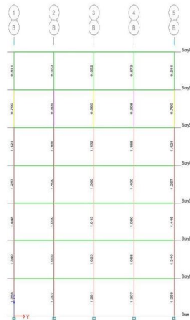
شکل ۳- نسبت باربری ستون‌های سازه ۷ طبقه- زمین نوع II- طبق ASCE 7-16
