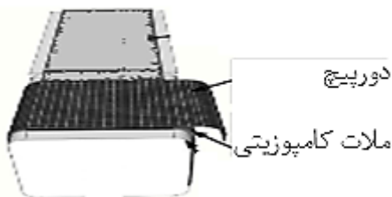
شکل ۱- تیر بتنی تقویت شده با کامپوزیت TRM و FRCM با الگوی STRIP
