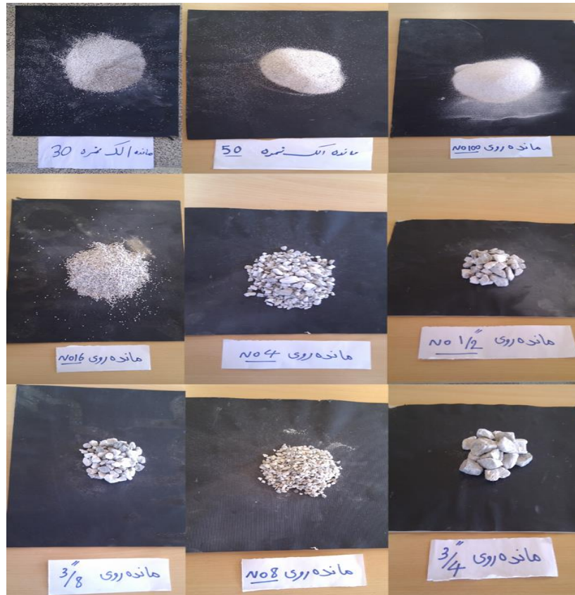
شکل ۲: سنگدانه‌های تهیه شده از جنس باریت به منظور ساخت بتن سنگین
