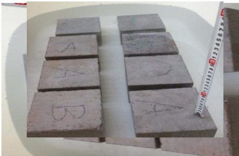
شکل ۱۶- مستغرق کردن نمونه ها در آب به مدت ۳۰ دقیقه برای آزمایش جذب آب نیم ساعته با ارتفاع ۲۵ میلیمتر آب روی نمونه ها
