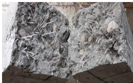
شکل ۱۲- آزمون شکسته شده بتن حاوی الیاف بارچپ HT 48
