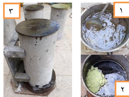
شکل ۱۰- مراحل کپی‌نگ نمونه‌ها- ۱- ذوب گوگرد ۲- اضافه کردن ماسه‌بادی به گوگرد ذوب شده ۳- قراردادن نمونه در دستگاه کلاک گذاری حاوی مخلوط گوگرد و ماسه بادی
