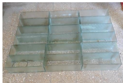
شکل ۷- قالب های شیشه ای ۱۰×۱۰×۳۵ میلی متر ساخته شده جهت تهیه نمونه برای انجام آزمایشات مقاومت خمشی و مقاومت ویژه الکتریکی
