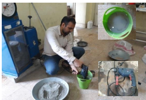
شکل ۸- نحوه تهیه ژل دوده سیلیسی
