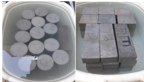
شکل ۹- عمل آوری نمونه‌ها در مخزن آب - آهک
