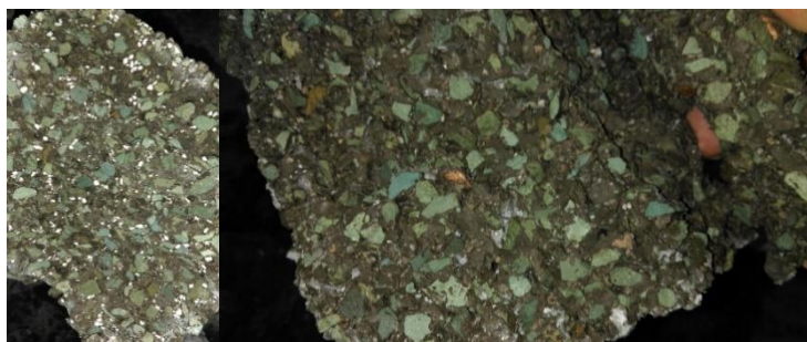
شکل ۶- مقطع بتن متخلخل به همراه افزودنی: پرلیت (سمت راست) و پوکة معدنی (سمت چپ)
