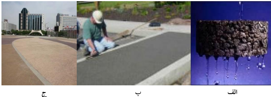
شکل ۱- الف- نمونه‌ای از بتن متخلخل ب- استفاده از بتن متخلخل در پیاده‌رو ج- استفاده از بتن متخلخل در پارکینگ‌ها
