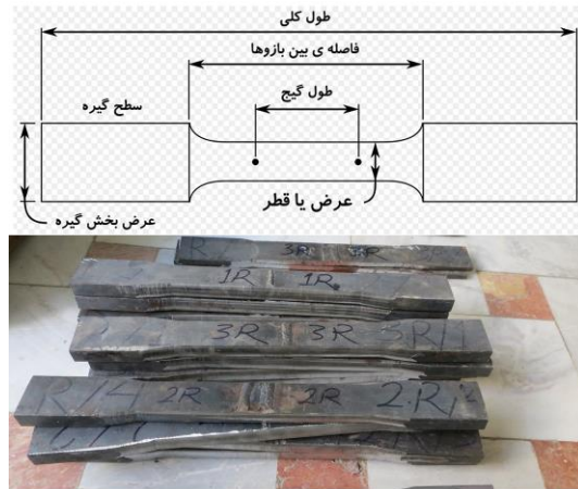
شکل ۵- نمونه‌های آماده‌سازی شده مطابق استاندارد برای آزمون کشش
