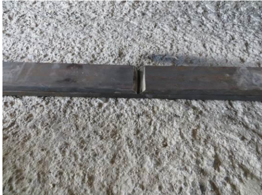
شکل ۲- طرح اتصال جوش لب به لب
