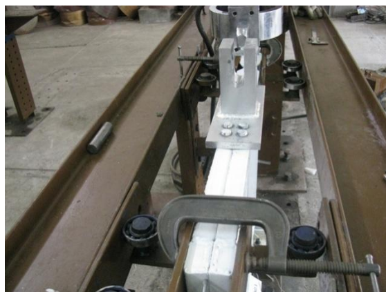
شکل ۴- نحوه‌ی مهار جانبی نمونه‌ی آزمایشگاهی
