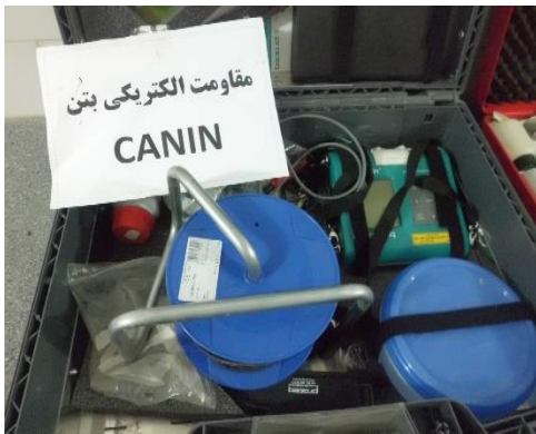
شکل ۱- دستگاه اندازه‌گیری پتانسیل خوردگی میلگرد استاندارد ASTM 876
