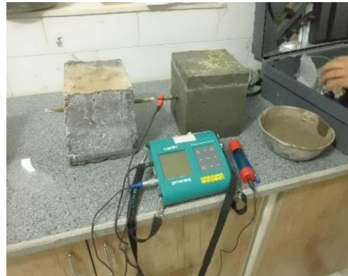
شکل ۲- آماده سازی دستگاه هالف سل جهت انجام تست خوردگی
