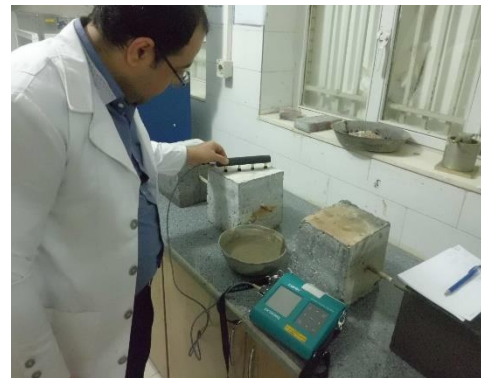
شکل ۳- انجام آزمایش اندازه گیری میزان مقاومت بتن در مقابل نفوذ یون کلر بوسیله دستگاه آلتراسونیک
