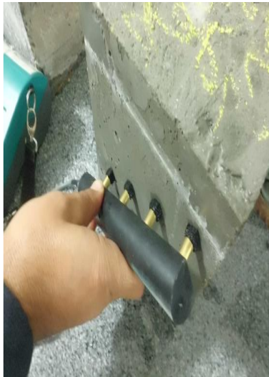
شکل ۵- مراحل انجام تست مقاومت الکتریکی بتن
