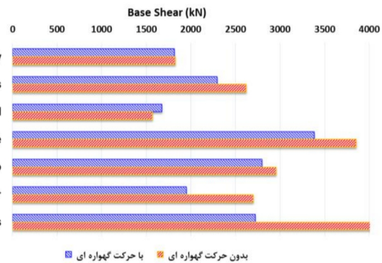
شکل ۱۵- مقایسه برش پایه سازه ۱۲ طبقه با رعایت بند آیین‌نامه، با و بدون در نظر گرفتن حرکت گهواره‌ای
