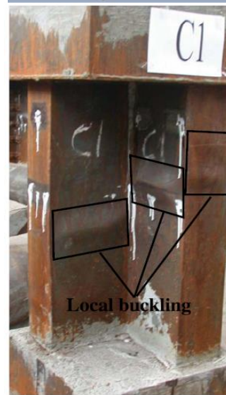
شکل ۹- شمای کلی نمونه مدلسازی شده با نرم‌افزار آباکوس و نمونه آزمایشگاهی صحت‌سنجی شده
