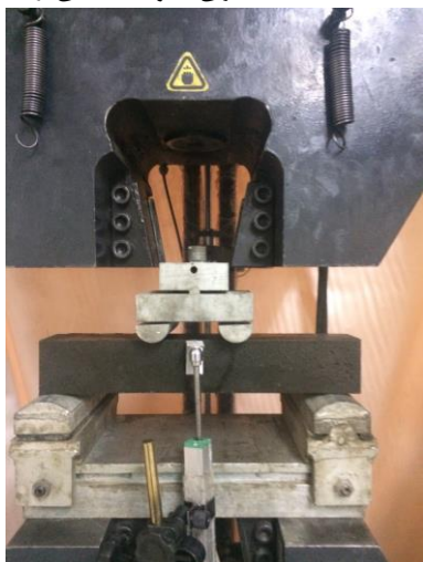
شکل ۳ (الف) نمای کلی بارگذاری چهار نقطه‌ای برای تعیین مقاومت خمشی و (ب) نحوه قرارگیری نمونه بتن فوق توانمند در دستگاه یونیورسال
