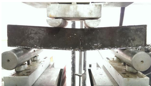
شکل ۱۱ نحوه شکست نمونه بتن فوق توانمند الیافی تحت بارگذاری خمشی
