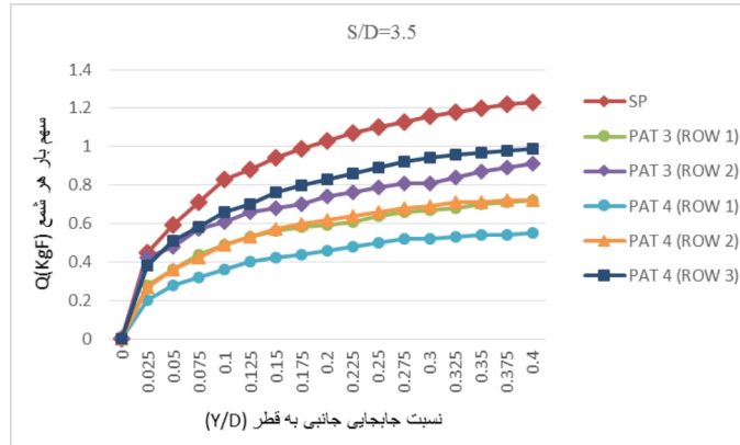
شکل ۹- پاسخ تغییرات نسبت جابجایی جانبی به قطر در برابر بار جانبی میانگین برای گروه شمع در دو حالت ۲×۲ و ۳×۲
