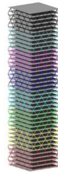
شکل ۱۲- تیپ‌بندی مقاطع اعضا در سازه دیاگرید تک لایه و مقاطع بهینه بدست آمده
