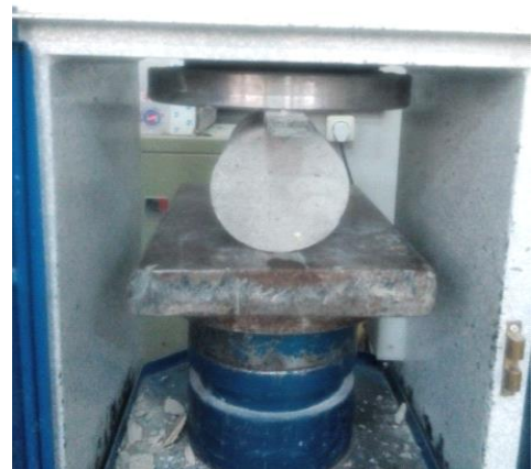
شکل ۷- آزمایش مقاومت فشاری (آزمایشگاه بتن)
