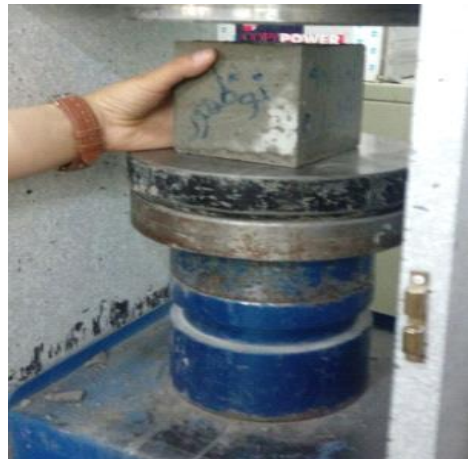
شکل ۶- آزمایش مقاومت فشاری (آزمایشگاه بتن)
